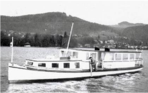
1918 | "Iseltwald" Brienzensee 1934 Umbau 3m länger mit Dieselmotor
